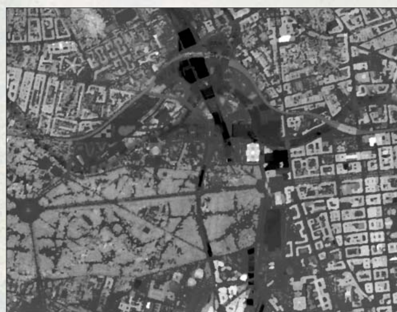
Abb. 5: Grauwertkodiertes Digitales Oberflächenmodell von Berlin-Tiergarten.
